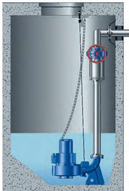
Погружной насос Amarex® KRT «мокрой» установки в приемном резервуаре, вид сбоку.
