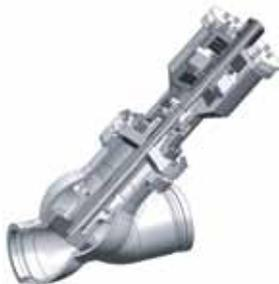
**Конструкция:** Приварной запорный клапан с сальниковой набивкой или сильфоном, разработанный для систем обеспечения безопасности, клапан типа Y, литой или кованный, изготовлен из углеродистой или нержавеющей стали.
