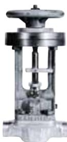
**Конструкция:** Фланцевый или приварной мембранный клапан с мягким уплотнением (тройной этилен-пропиленовый каучук), изготовленный из углеродистой / нержавеющей стали или чугуна с шаровидным графитом, с гуммированием.
