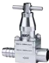
**Конструкция:** Запорный мембранный клапан с патрубками под приварку или шланговое соединение. Запор и внешнее уплотнение посредством мембраны; с встроенной защитой штока, изготовлен из нержавеющей стали.
