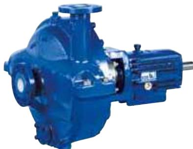
**Конструкция:** Горизонтальный центробежный насос со спиральным корпусом с поперечным разъемом, по стандарту API 610, 11 издание, или ISO 13709 (для тяжелых режимов работы), с радиальным рабочим колесом, одноступенчатый, однопоточный, с осевыми опорами; при необходимости оснащается предвключенным шнеком. Возможно исполнение по АТЕХ.
