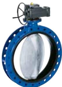
**Конструкция:** Центрический дисковый дроссельный затвор с кольцевой вставкой из эластомера. С рычагом, редуктором с ручным управлением, пневматическим, электрическим или гидравлическим приводом. Корпус с центрирующими дужками (T2) или U-образный корпус с фланцами без выступающей кромки (T5).
