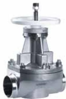
**Конструкция:** Запорный мембранный клапан с патрубками под приварку. Запор и внешнее уплотнение посредством мембраны; ручное, электрическое или пневматическое уплотнение; изготовлен из углеродистой или нержавеющей стали.
