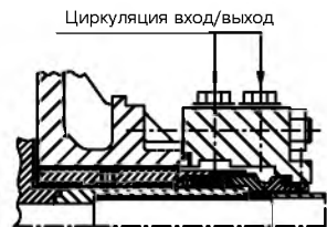
Торцовое уплотнение с воздушным охлаждением теплообменника
